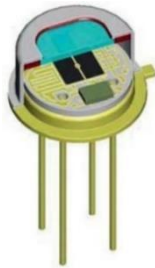
温补型数字 PIR 火焰传感器结构
